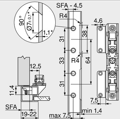
Pour une largeur de cadre 19 mm un recouvrement latéral SFA de 11-18 mm est possible
