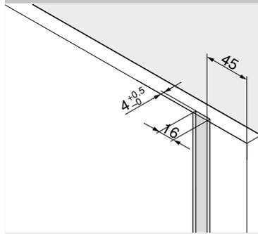
**Cotes de perçage – tringle de verrouillage**
