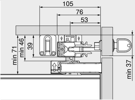
**Cotes de fraisage – tringle de verrouillage**
