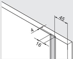
Cote de perçage de la tringle de verrouillage
