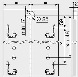
\* +1 mm en cas de montage de la coulisse corps de meuble avant l'assemblage du corps de meuble
