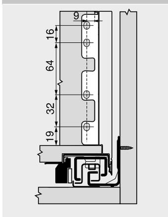
\* +1 mm en cas de montage de la coulisse corps de meuble avant l'assemblage du corps de meuble
