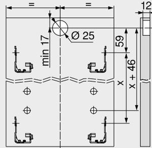
\* +1 mm en cas de montage de la coulisse corps de meuble avant l'assemblage du corps de meuble
